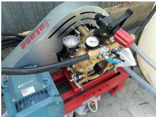
Figura 2. Conexión de la bomba a la tubería del invernadero.
