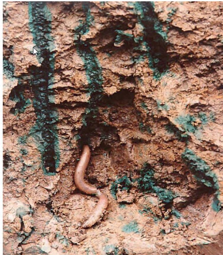
Figura 7: Patrón de flujo de agua en el perfil de suelo (lado izquierdo) y patrón de tinción de macroporos (lado derecho) visible mediante experiencias de infiltración con trazador de color (Ref. 9).
